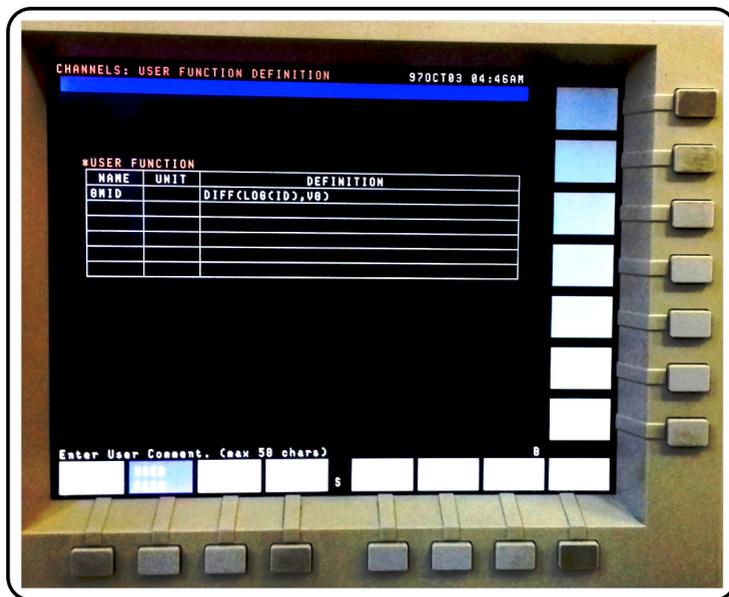
**Figura C.3:** Passo 2 - equação para extração da característica  $g_m/I_D$ .
