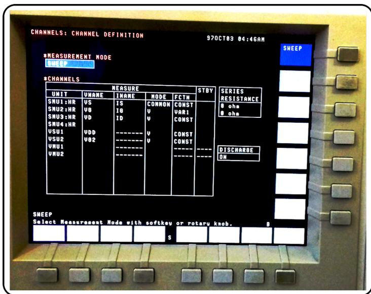
**Figura C.2:** Passo 1 - seleção dos pinos para excitação elétrica.
