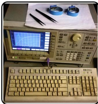
**Figura 6.1:** Analisador de parâmetros Agilent 4156C.
