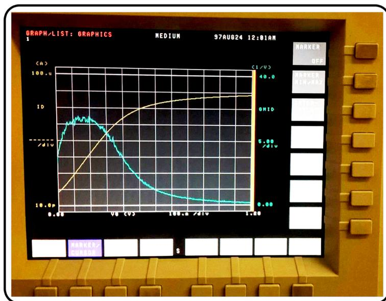
Figura C.5: Passo 4 - extração das curvas do transistor.
