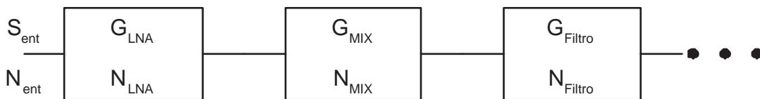
Figura 2.6: Fator de ruído para componentes em cascata.
